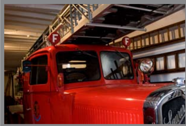
Première échelle du poste permanent (1931). Echelle 30m Metz sur châssis Saurer
