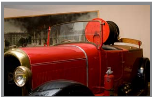
Delahaye (1924) Fourgon premier-secours - pompe 1000 l/min à 8bar
